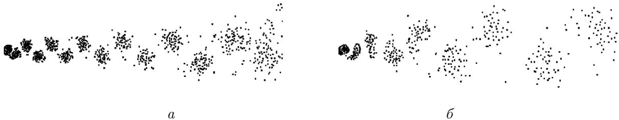
Рис. 3. Вихревая дорожка Кармана:  $t = 70$ ,  $Re = 100$  (а) и  $1000$  (б)
