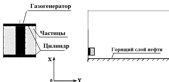
Рис. 2. Схема тушения разлива нефти
