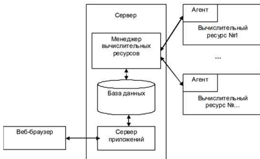
Рис. 1. Структура системы удаленного доступа и управления распределенными вычислительными ресурсами
