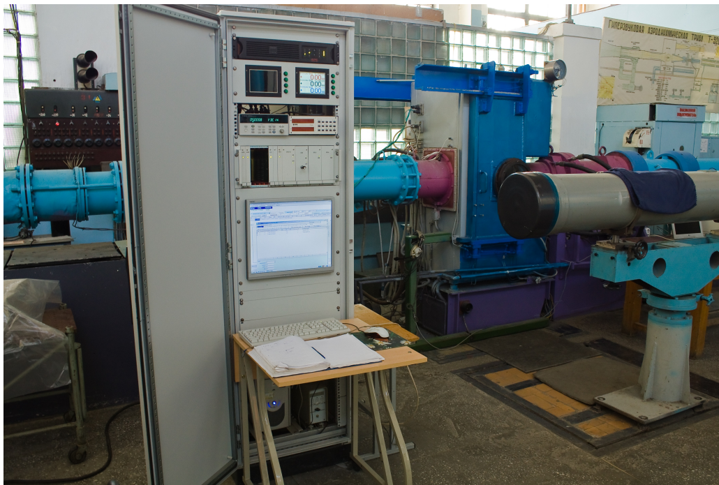
Рис. 3. Система автоматизации трубы Т-326
