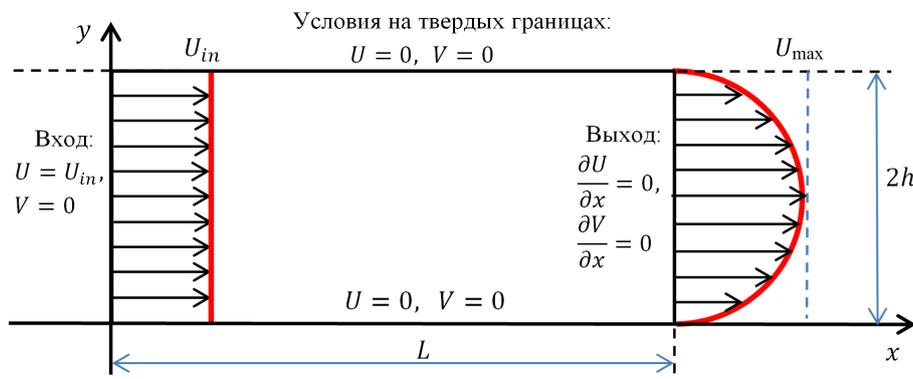
Рис. 3. Иллюстрация постановки задачи ламинарного течения в начальном участке плоского канала
