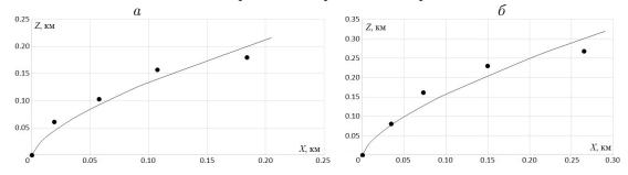
Рис. 3. Численно восстановленные по зависимости (2) и спутниковому снимку от 06.12.2019 г. (см. рис.  $1, \delta$ ) траектории дымовых шлейфов от 330-метровой (a) и 190-метровой  $(\delta)$  труб Гусиноозерской ГРЭС
