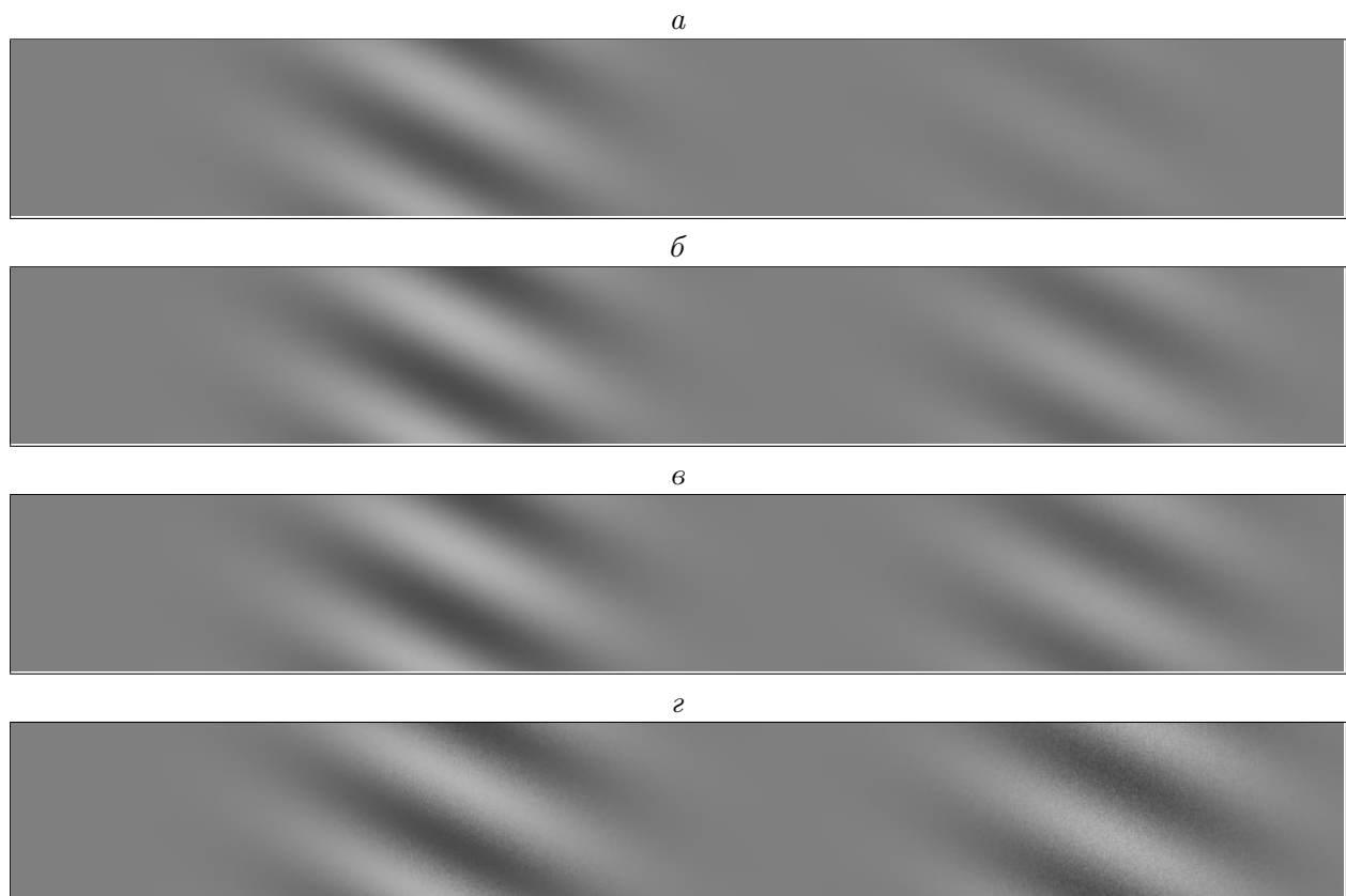
Рис. 3. Изображения морского дна, полученные по данным с повышенной точностью: по данным измерений антенной с шириной диаграммы направленности \epsilon_1 = 3^\circ (а), экстраполированным данным двух измерений антеннами с шириной диаграмм направленности \epsilon_1 = 3^\circ и \epsilon_3 = 4^\circ (б), экстраполированным данным двух измерений с шириной диаграмм направленности \epsilon_1 = 3^\circ и \epsilon_2 = 3.5^\circ (в), экстраполированным данным трех измерений с шириной диаграмм направленности \epsilon_1 = 3^\circ , \epsilon_2 = 3.5^\circ и \epsilon_3 = 4^\circ (г)
